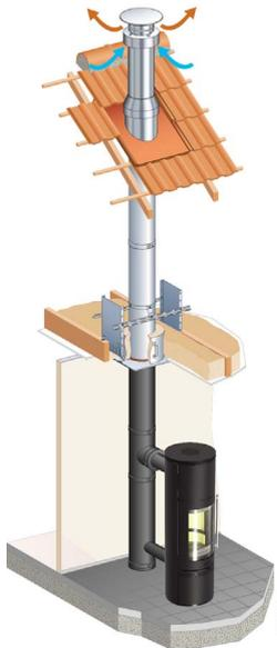
**i** Aucun poêle **non étanche** ne peut être raccordé sur un conduit concentrique.
