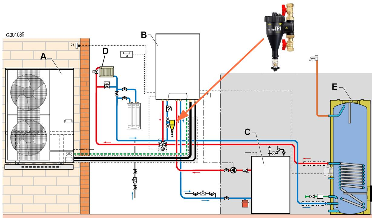
A : Unité extérieure - B : Module intérieur - C : Chaudière en appoint hydraulique - D : Circuit chauffage
