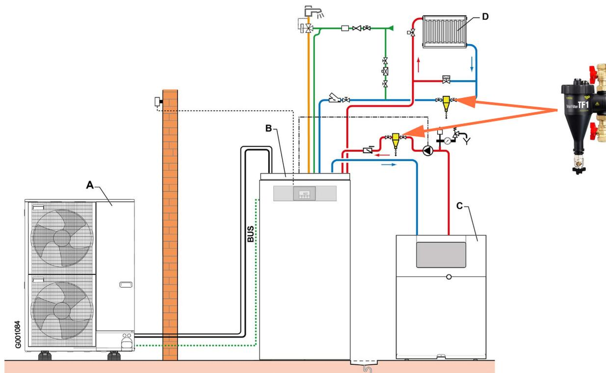
A : Unité extérieure - B : Module intérieur - C : Chaudière en appoint hydraulique - D : Circuit chauffage
