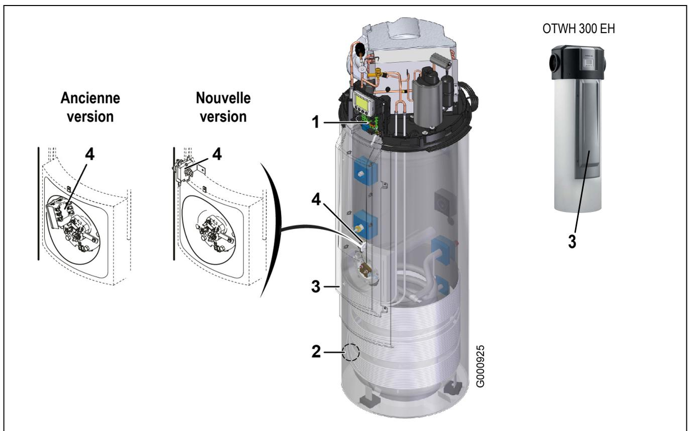
1. Nouvelle carte électronique PCU-195 avec nouvelle version programme 1.5 (Pour le détail des modifications voir ci-après). La nouvelle carte est compatible avec les versions d'appareils antérieures.
