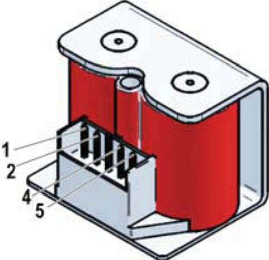
Mesure de la valeur ohmique des bobines de la vanne gaz :
