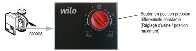
**1 - 3 - 6** Hauteur manométrique en mètres de colonne d'eau (mCE ou H/m sur le graphe ci-dessous)
