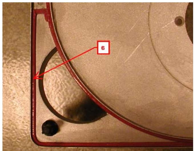
5. Ajout d'une gorge d'étanchéité, suppression du joint d'étanchéité et utilisation dorénavant d'un seul type de came (came standard pour rationalisation - non représentée ici, livrée en PR uniquement pour les brûleurs flux forcé)
