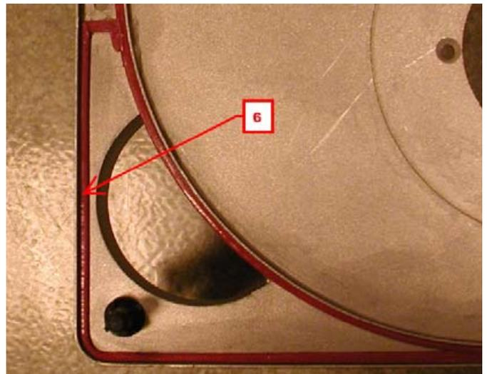
5. Hinzufügen einer Dichtungsrille, Wegfall der Dichtung und künftig nur noch eine Art von Nockenscheibe (Standard-Nockenscheibe zur Rationalisierung - hier nicht dargestellt, als Ersatzteil nur für die Gebläsebrenner für Luft-/Abgassysteme lieferbar)
