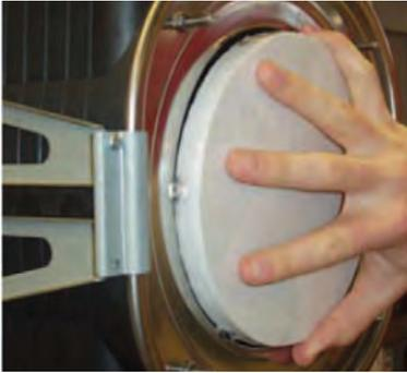
▶ Isolierung am Eingang des Feuerraums positionieren,
