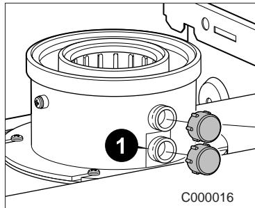
**Mesure de la teneur en CO<sub>2</sub> des fumées à l'aide de l'appareil de mesure.**
