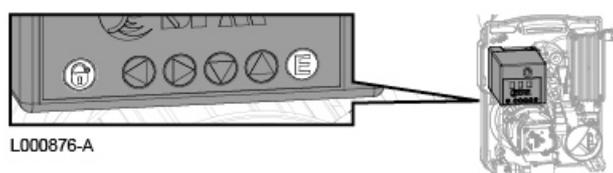
1. Pour amorcer la pompe fioul, mettre le brûleur en sécurité par un **appui long** sur la touche
